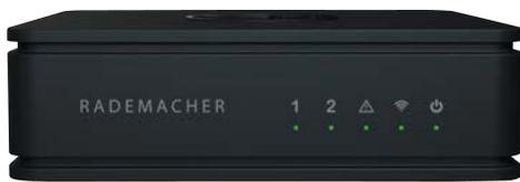
**1.** DuoFern USB-Stick einstecken und den HomePilot® mit dem beiliegendem LAN Kabel an Ihren Internet-Router anschließen. Als Nächstes **kann** der HomePilot® per HDMI an Ihren Fernseher angeschlossen werden. Nun kann der HomePilot® bereits an das Stromnetz angeschlossen werden.
